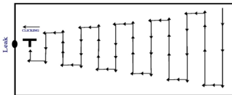
La plupart des fuites sont découvertes pendant que vous déplacez la sonde dans le sens qui produise un gémissement, puis tout d'un coup le signal s'arrête. Cela indique que la sonde a passé au-dessus de la fuite et est maintenant pointant vers l'extérieur. Tournez la sonde autour et examiner attentivement la zone juste passé.
