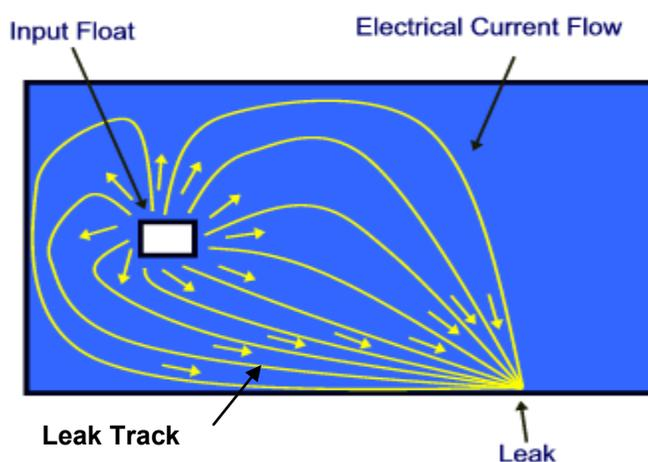
Le LeakTrac 2400 sophistiqué détecte ces "Leak Tracks", en mesurant le potentiel de tension différentielle à différents points de la piscine, et traduit cette information en les sons cliquant qui augmentent de fréquence quand les tensions différentielles augmentent.
